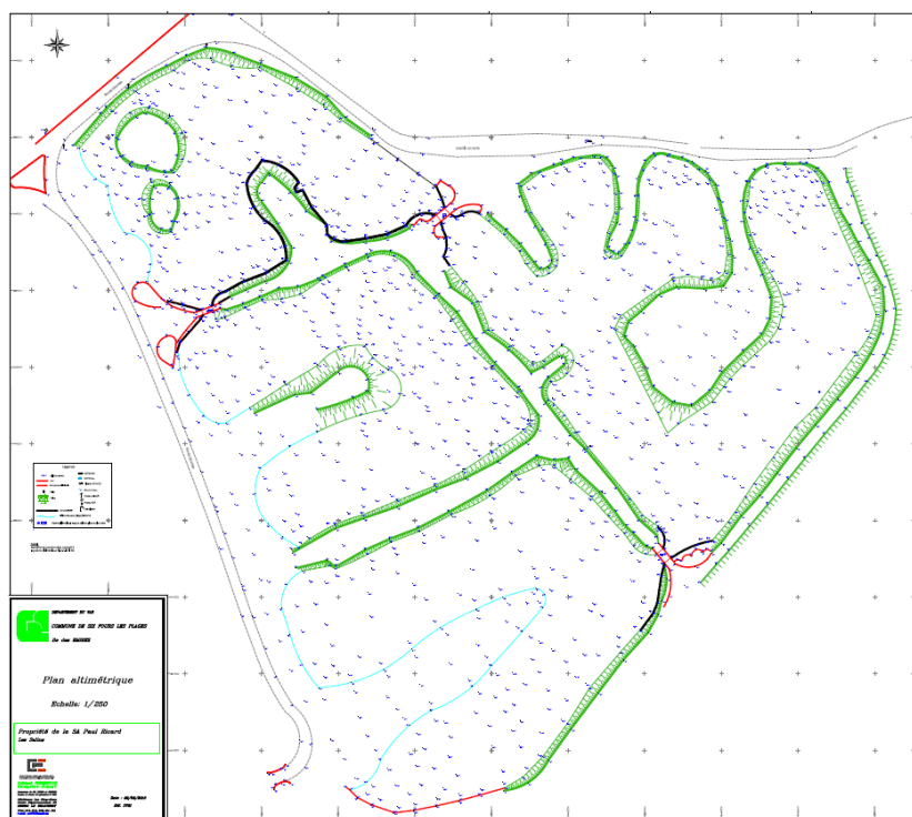
Figure 160 : Plan altimétrique détaillé des anciens salins, réalisé par géomètre en 2018 (précision au 1/500e).
