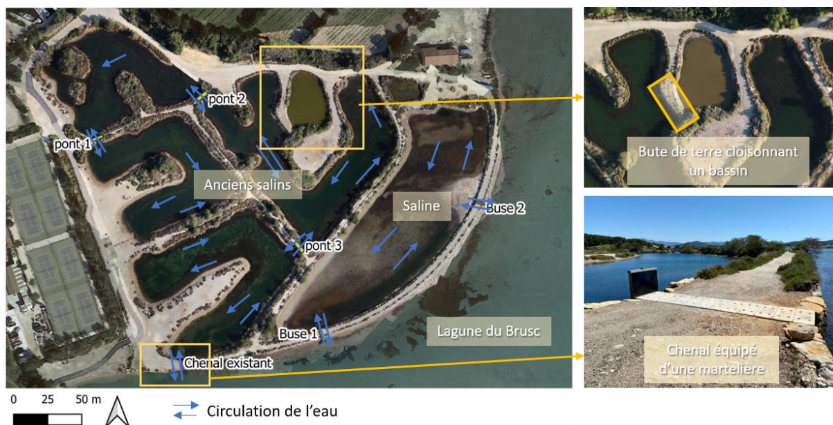
Figure 167: Schéma de la circulation de l'eau après les travaux. Vue d'ensemble des ouvrages hydrauliques (chenaux, buses, ponts), du sens des flux (flèches bleues), et des zones de confinement.
