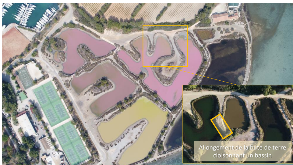
Figure 163 : Plan de compartimentation d'une partie du bassin ouest — rôle ciblé pour l'avifaune marine.
