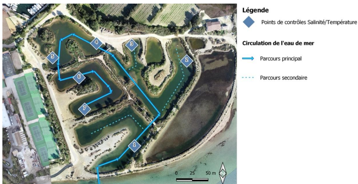
Figure 168 : Localisation des points de mesure (salinité/température) et visualisation des parcours d'écoulement principaux et secondaires.
