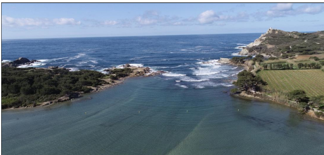
Figure 5 : Atténuation de la houle du large dans la passe par l'action combinée de la réduction de la hauteur d'eau et du petit récif barrière de posidonie.
