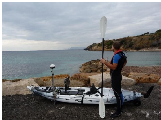
Figure 24 : kayak instrumenté d'un sondeur acoustique monofaisceau eBEEEM, d'un système complet de géoréférencement, d'outils de navigation, d'une centrale d'acquisition de données.
