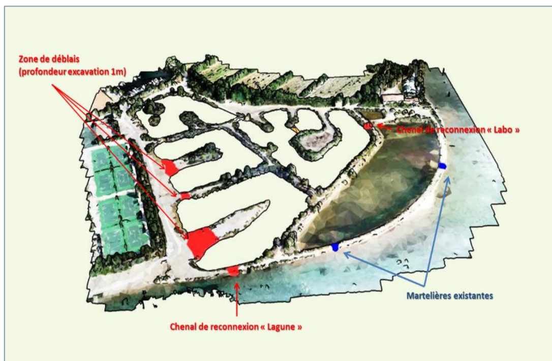
Figure 159 : Modélisation en 3D de la zone des anciens salins, illustrant les zones de déblais (profondeur 1 m) et les propositions de reconnections hydrauliques avec la lagune et le bassin « saline », proche du laboratoire de l'IOPR.
